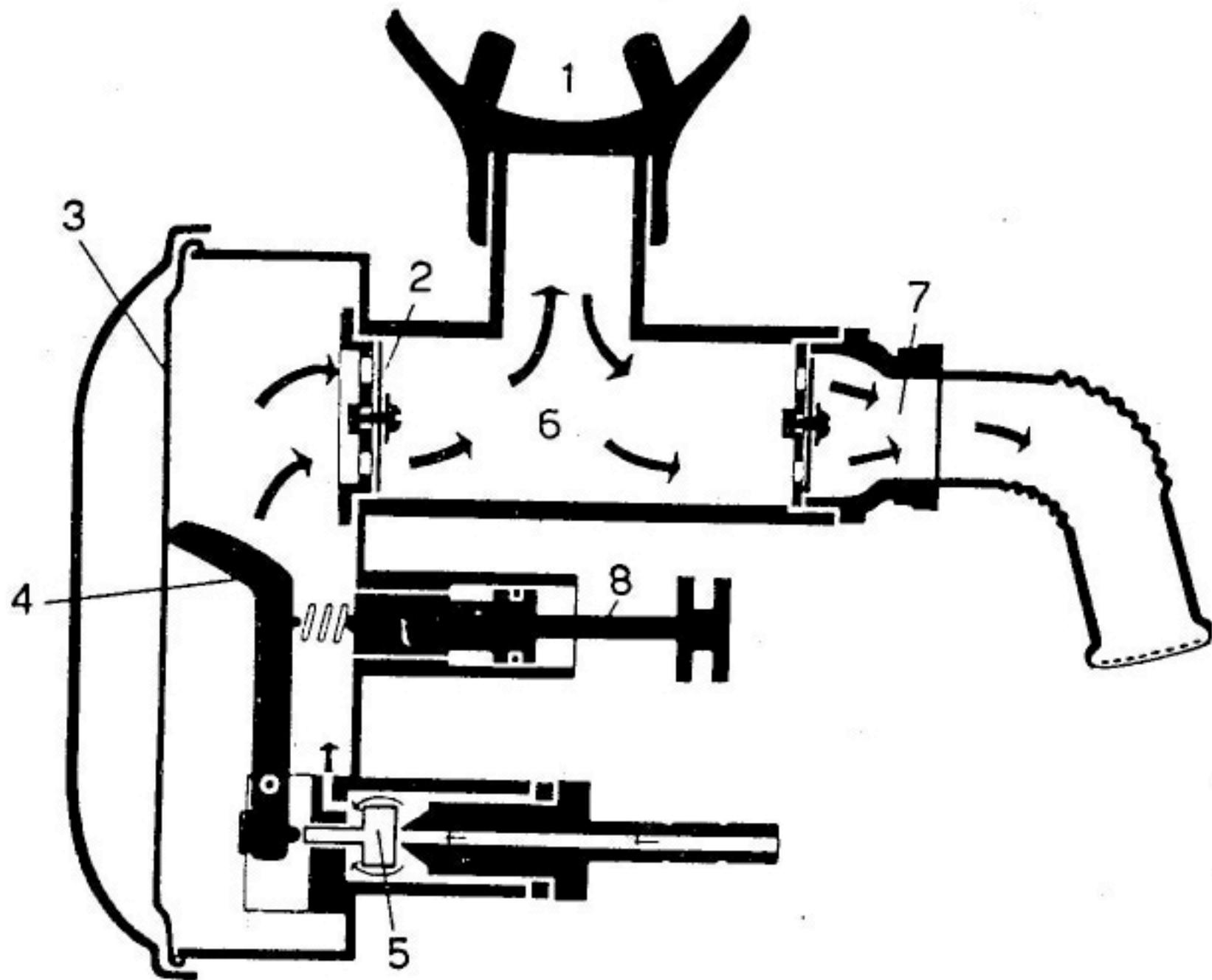
*Schema di funzionamento dell'erogatore dell'Abissal normale.*
