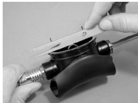
Fig. 24– Checking Lever Height
